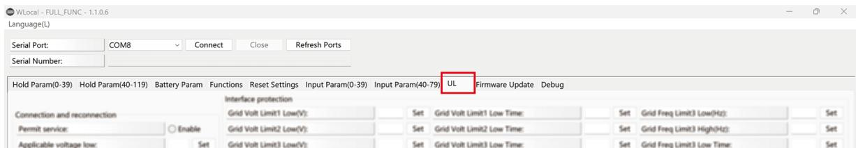
3. En esta página, puede activar la función de la Norma 21. Ingrese el valor en el espacio correspondiente. Antes de configurarlo, puede leer primero el valor predeterminado y luego establecer el parámetro de la función que necesita ser modificado de acuerdo con el rango de configuración de parámetros proporcionado en el siguiente capítulo 8.2.
