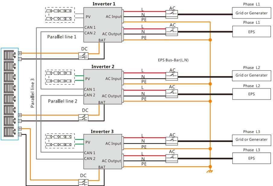
Si prega di inserire il PIN di comunicazione CAN in stato di accensione per il primo e l'ultimo inverter.
