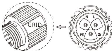
c) Assemblare il connettore GRID e assicurarsi che la filettatura della morsetteria e la scanalatura sull'alloggiamento si inseriscano perfettamente fino a quando non si sente o si avverte un "click".
