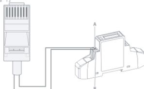
Passo 3. Controllare la connessione. Quando lo strumento visualizza -xxxW, l'inverter ibrido sta immettendo energia in rete, mentre quando visualizza xxxW, significa che il carico della casa sta prelevando energia dalla rete.
