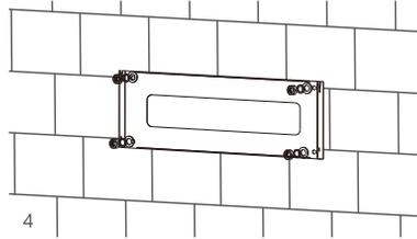
**Passo 3.** Installare l'inverter sulla staffa di montaggio sulla parete e fissare l'inverter con le viti di sicurezza.
