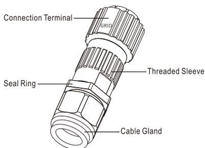
a) Inserire il cavo CA attraverso il passacavo, l'anello di tenuta e il manicotto filettato e inserire completamente i conduttori ai terminali corrispondenti sul terminale di collegamento e stringere le viti.
