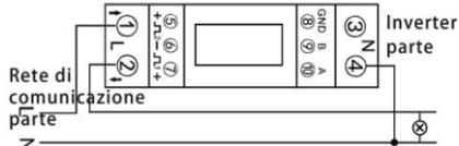
Passo 2. Collegare il cavo di comunicazione tra l'inverter e il contatore e collegare il cavo RJ45 alla porta di comunicazione
