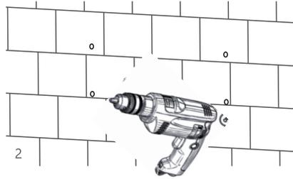
**Passo 2.** Per installare e fissare la staffa sulla parete, inserire i tasselli nei fori e fissare la staffa utilizzando le viti ad espansione (in dotazione insieme ai tasselli).
